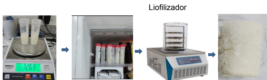
Figura 2.16. Liofilización de la muestra de celulosa fibrilada obtenida a partir del raquis de plátano ( Musa paradisiaca ).
