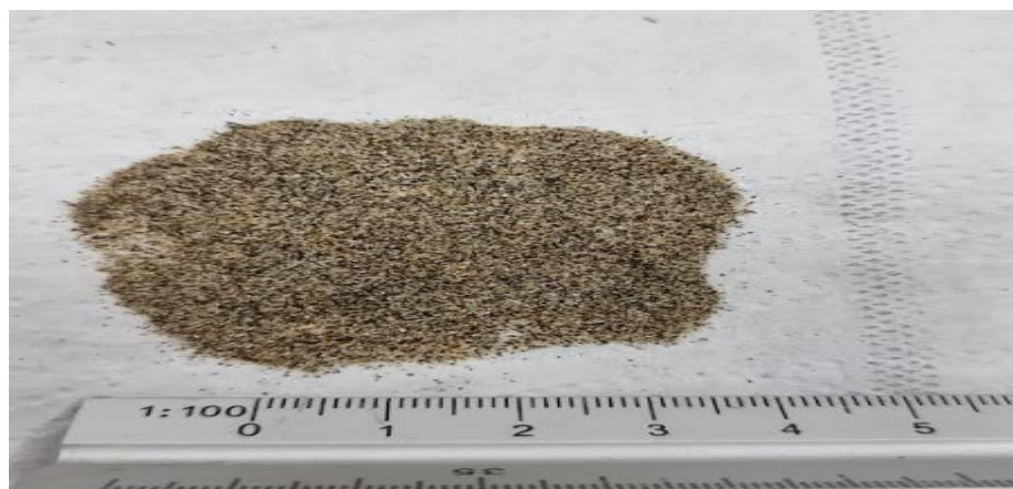
Figura 5.23. Arena tamizada, lavada y seca, empleada para la formación del tapón o medio poroso.
