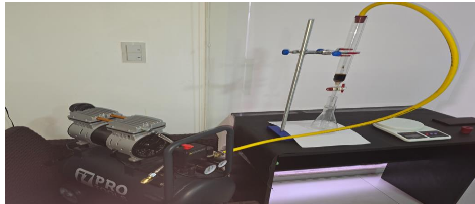
Figura 5.21. Sistema bidimensional sencillo para simular y modelar los flujos de los CMNC en la recuperación de hidrocarburos.
