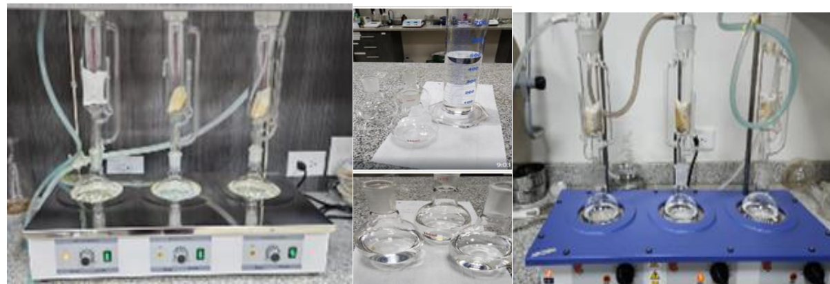
Figura 1.11. Remoción de compuestos extraíbles del raquis de plátano verde mediante extracción en equipo Soxhlet.
