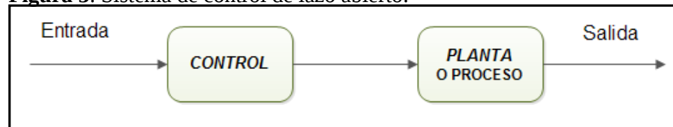
Figura 3: Sistema de control de lazo abierto:
