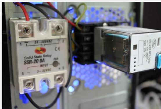
**Figuras 2.16.** Relés de Control. Derecha: Relé de Sensores de Final de Carrera, Izquierda: Relé de Sensores de Seguridad.
