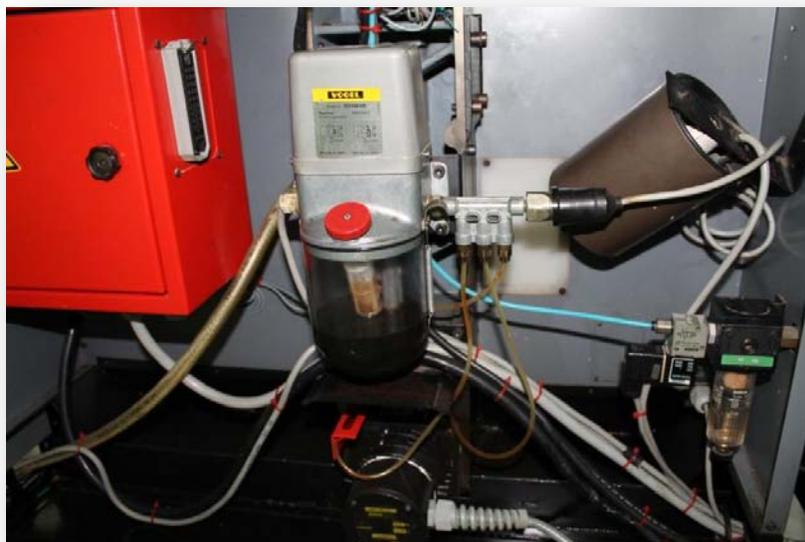
**Figuras 2.22.** Central de Lubricación (b) Iluminación (c) Válvula de Aire Comprimido.
