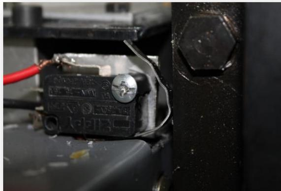
**Figuras 6.5.** Detalle de Sensor de Accionamiento Mecánico para el Paro del Husillo.
