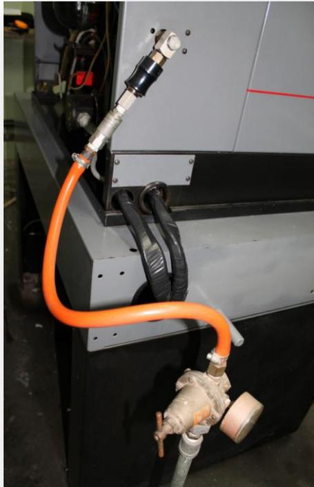
**Figuras 2.23.** Conexión a la Línea de Aire Comprimido
