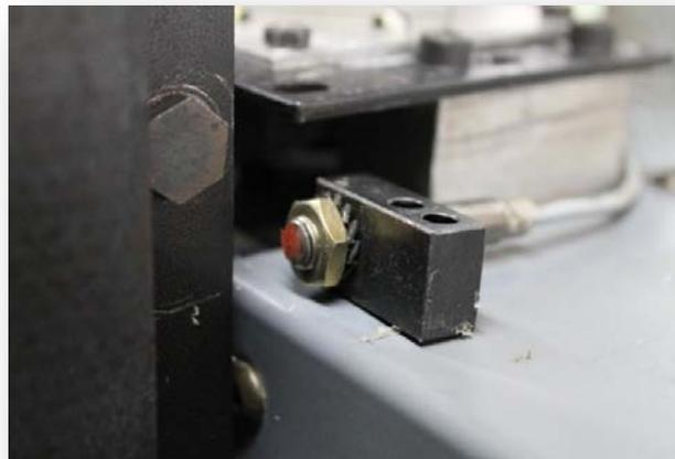
**Figuras 6.2.** Sensores de Proximidad de Tipo Inductivo (Detalle)
