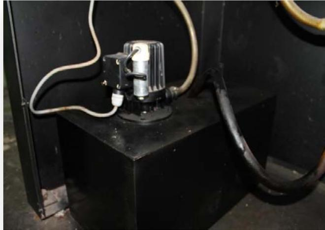
**Figuras 2.20.** Tanque y Bomba de Refrigerante
