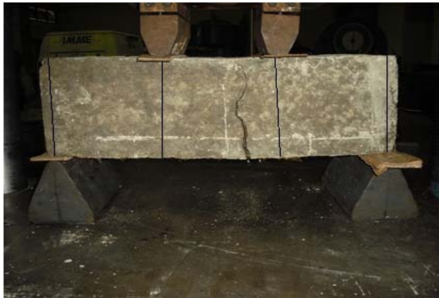
Figura 49. Viga ensayada según Norma Covenin 342:2004. Fuente: Propia
