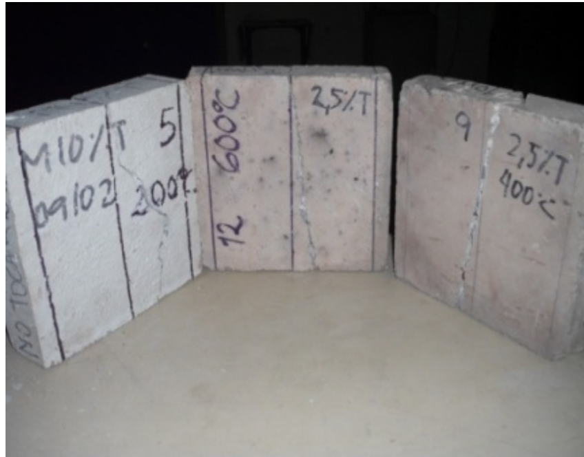
Figura 57. Losas sometidas a altas temperaturas, para las mezclas de concreto reforzadas con fibras de coco tratadas químicamente.
