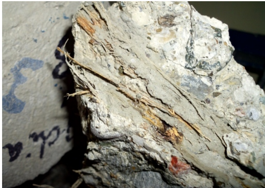
Figura 70. Falla de las fibras de bagazo de caña de azúcar reforzando mezclas de concreto.
