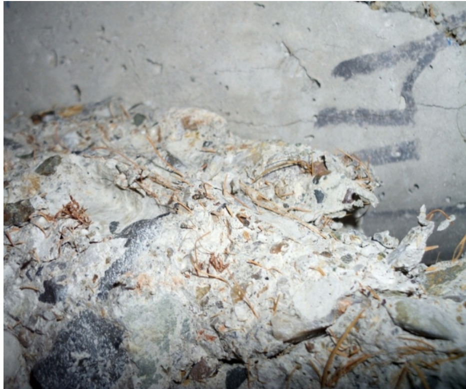
Figura 46. Menor grado de descomposición para las fibras expuestas a la matriz de concreto sin tratamiento para un tamaño corto.
