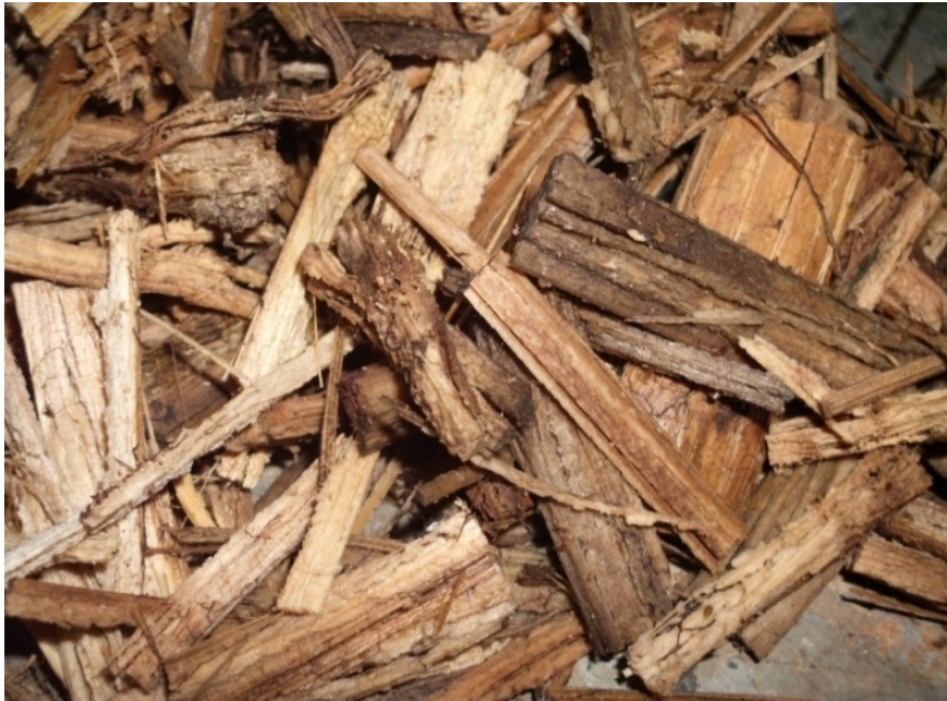
Figura 80. Fibras de bagazo de caña de azúcar no tratada con indicios de descomposición
