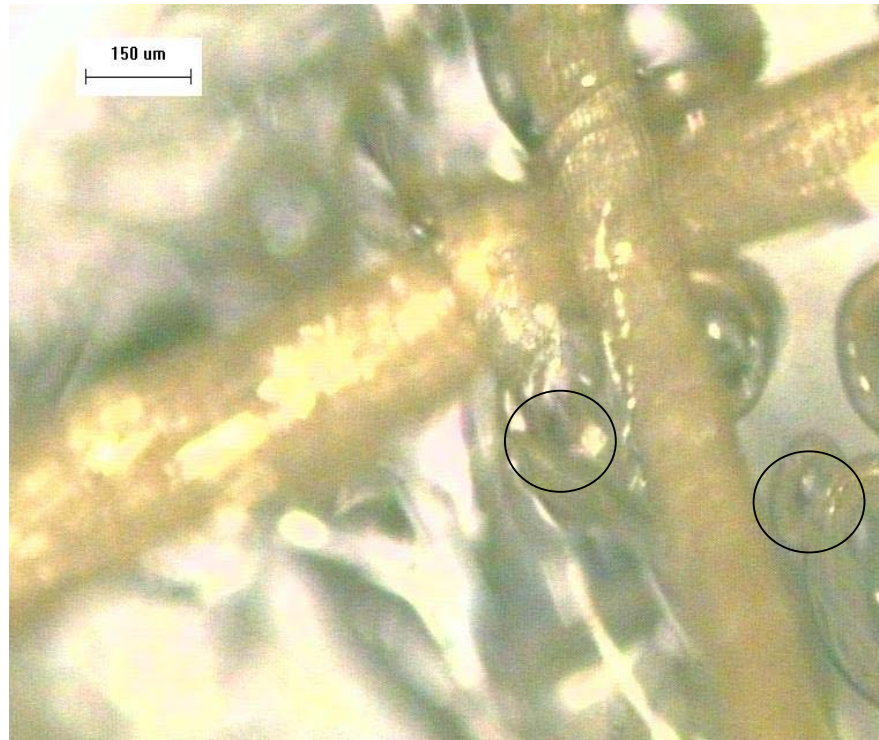
Figura 34. Conglomerado de fibras de coco tratadas químicamente con NaOH y recubiertas con PMMA vista microscopía óptica con aumento 5x
