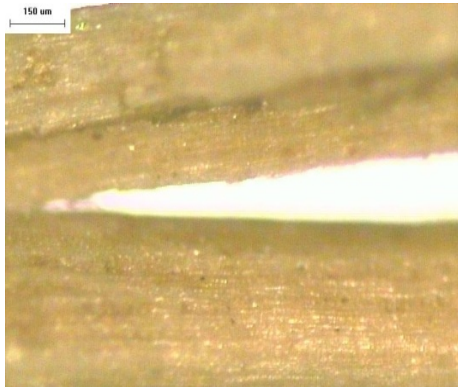
Figura 31. Fibras de coco sin tratar vista microscopia óptica aumento 5x Fuente: Propia
