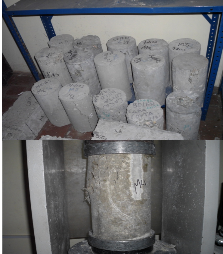
Figura 71. Mezclas de concreto reforzado con fibras de bagazo de caña de Fuente: Propia
