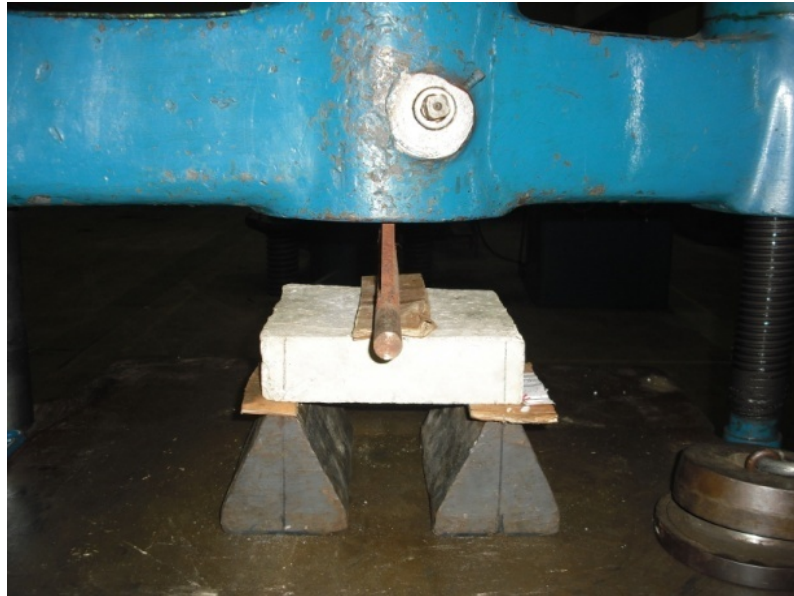
Figura 21. Ensayo de resistencia a la tracción por flexión para losas.
