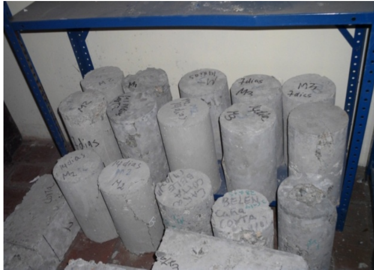
Figura 81. Concreto reforzado con fibras experimentando buena tenacidad Fuente: Propia
