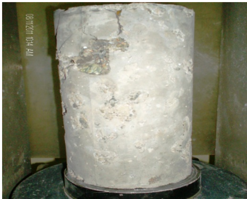
Figura 48b. Falla de una probeta de concentración 2,5% fibra tratada en el ensayo de resistencia a la compresión
