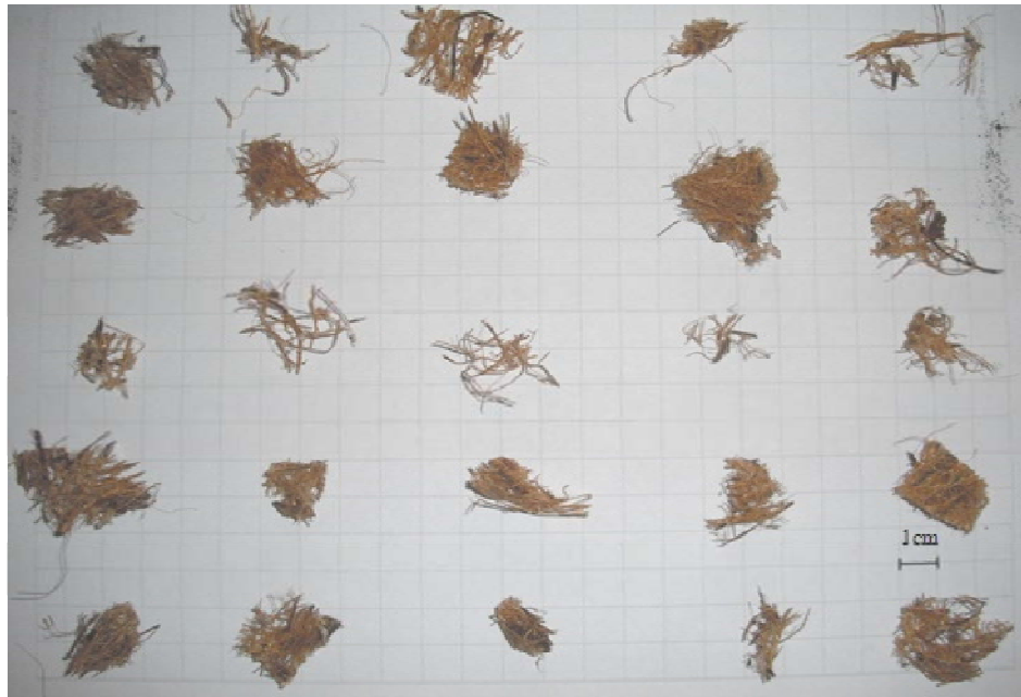
Figura 14. Fibras de coco tratadas con polimetilmetacrilato distribución aleatoria tamaño ( \leq 4\text{cm} ).
