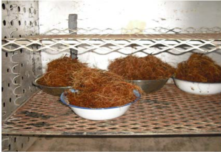
Figura 12. Fibras de coco en la estufa a 70°C
