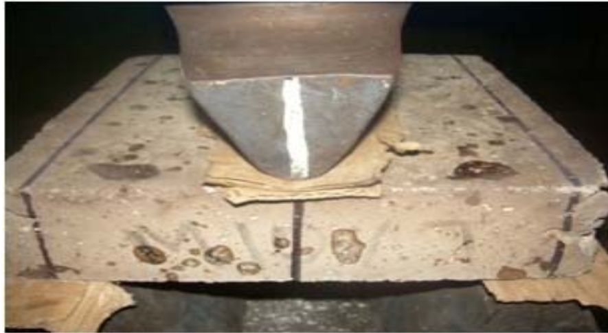
Figura 66. Losa reforzada con fibras de coco tratadas químicamente al 10 % en volumen sometida a 400°C.
