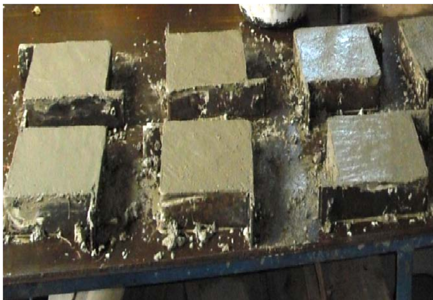
Figura 20. Probetas rectangulares en moldes metálicos no normalizadas (Losas). Fuente: Propia
