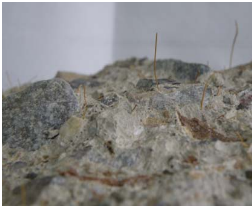
Figura 51. Fracturas de las fibras de coco después de ensayada una viga
