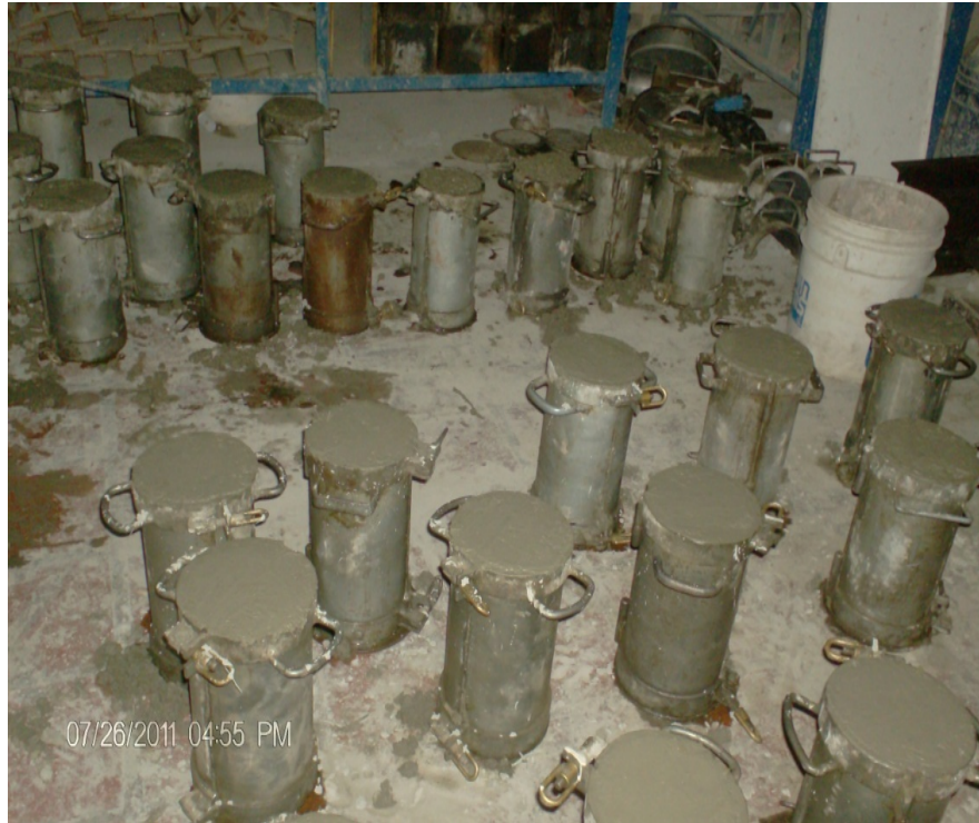
Figura 19. Cilindros en moldes de superficie interior liso y material no reactivo a las mezclas de concreto
