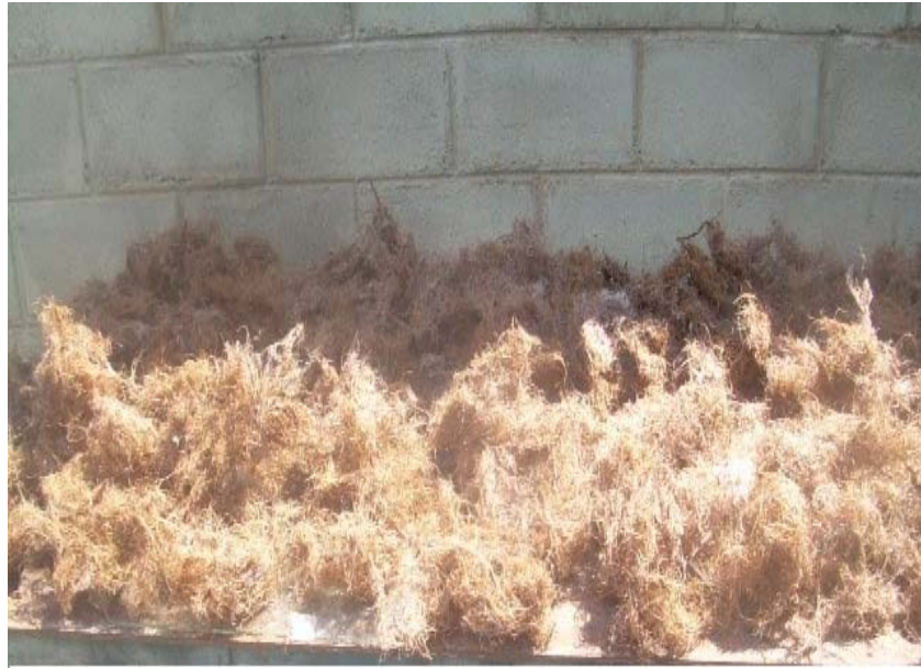
Figura 13. Fibras de coco tratadas químicamente con NaOH e impregnada con (PMMA)
