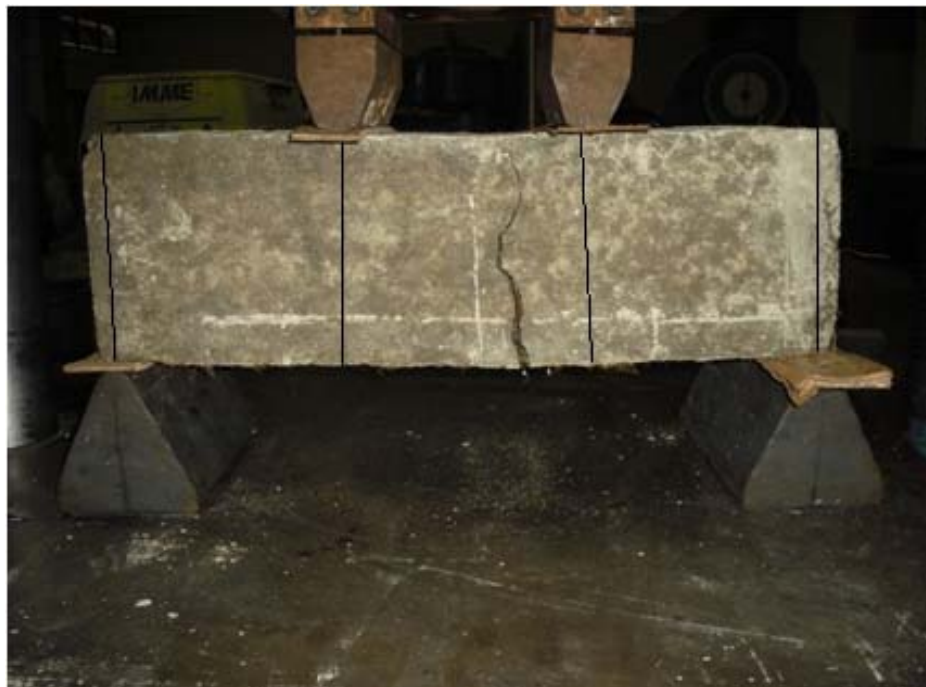
Figura 23. Ensayo de viga según Norma COVENIN 342:2004
