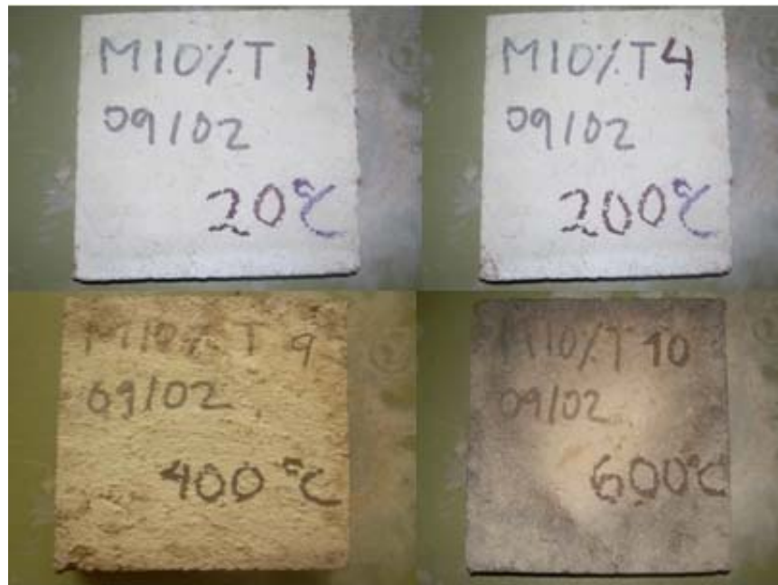
Figura 65. Losas reforzadas con fibras de coco sometidas a las altas temperaturas Fuente: Propia
