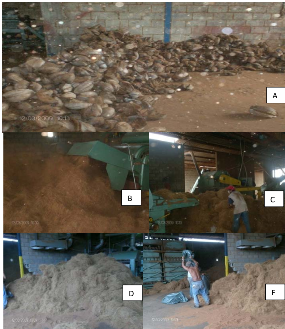
Figura 11. Proceso de obtención de las fibras de coco en la Empresa Coconut estado Falcón;(a) conchas de coco (b) proceso mecánico de las fibras de coco (c) obtención de las fibras (d) proceso terminado, conchas de coco desfibradas (e) fibras embolsadas para su distribución.
