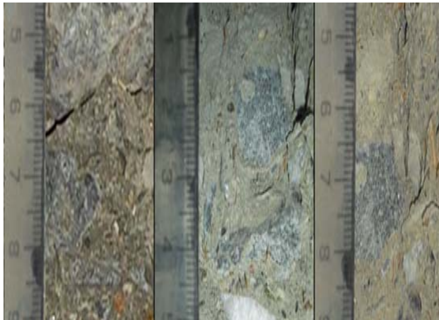
Figura 42. Distribución de los agregados en el concreto a) patrón vista la izquierda b) 5% de fibras tratadas vista al centro y c) 2,5% de fibras tratadas vista derecha
