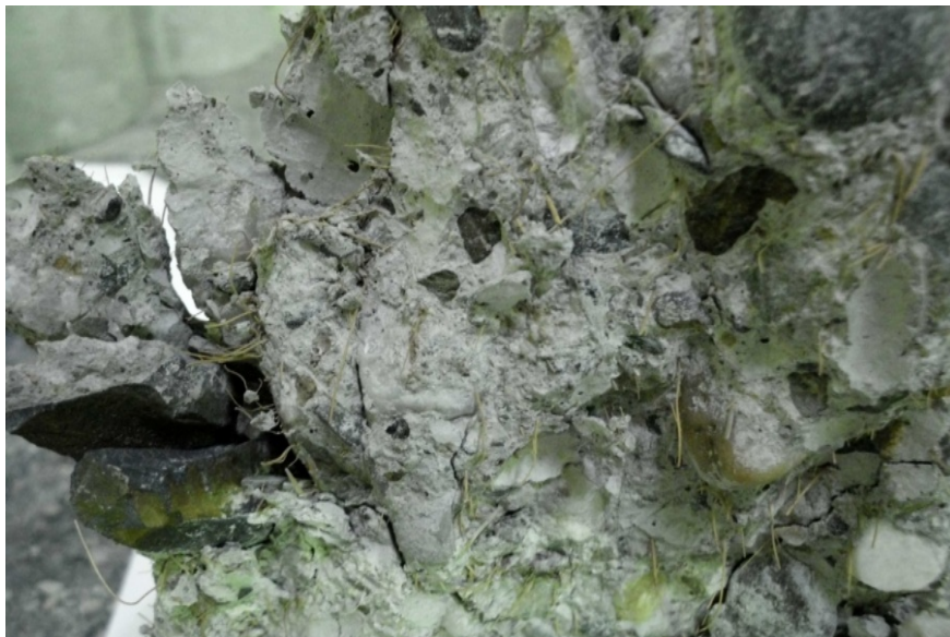
Figura 45. Mezclas reforzadas con fibras de coco sin tratamiento sin disgregación de los materiales
