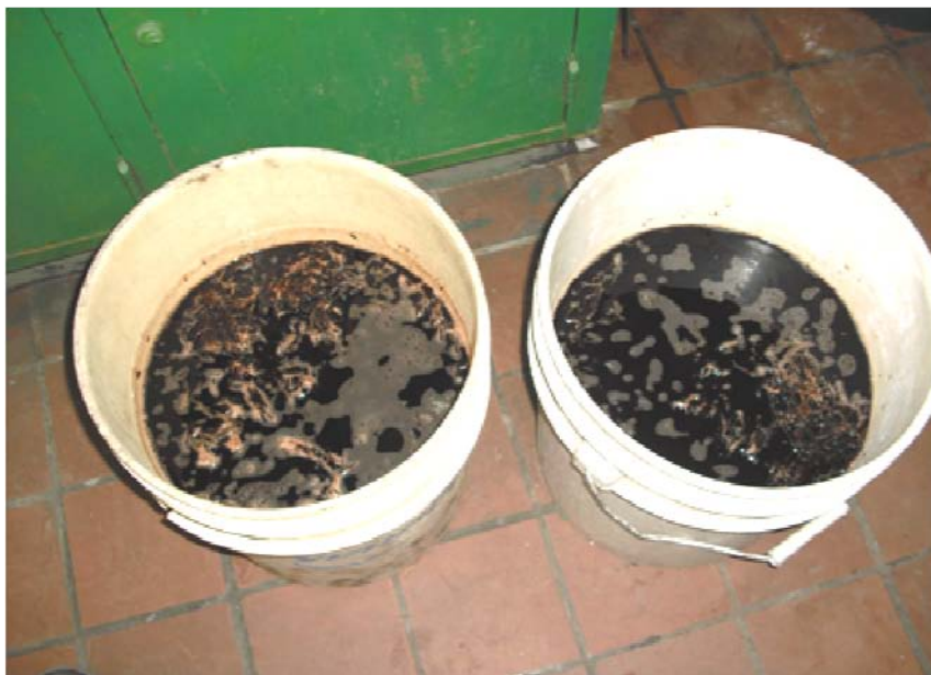
Figura 30. Fibras de coco a la izquierda y fibras de bagazo de caña de azúcar a la derecha sumergidas en la solución de NaOH
