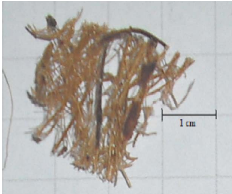
Figura 29. Fibras de coco tratadas químicamente con NaOH y recubierta con PMMA
