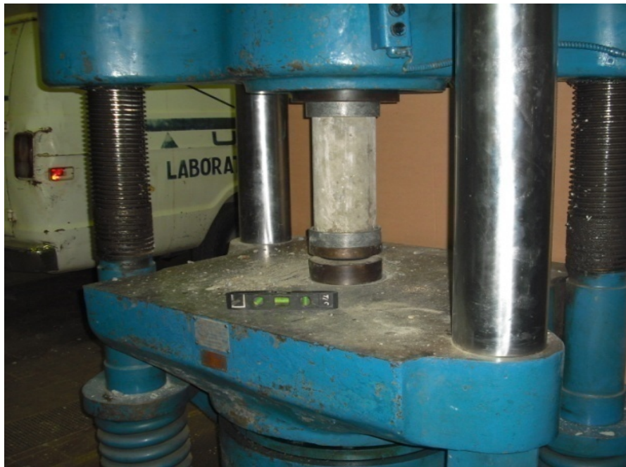
Figura 17. Ensayo a compresión de cilindro
