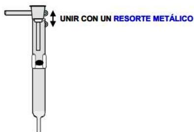
**Figura 21.** Pinzas laterales para ajustar el vástago y la columna del reactor.
