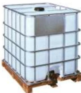
Depósito o contenedor de 1.000 litros fabricado en polietileno de alta densidad y alto peso molecular (PEAD-APM), con estabilizante UV. Jaula de perfil cuadrado de acero galvanizado construida por electrosoldadura automática. Válvula de 2" fabricada en polietileno de alta densidad (PEAD) por inyección con tapón autoprecintable y provista de codo de vaciado. Tapa roscada de 150mm de diámetro
