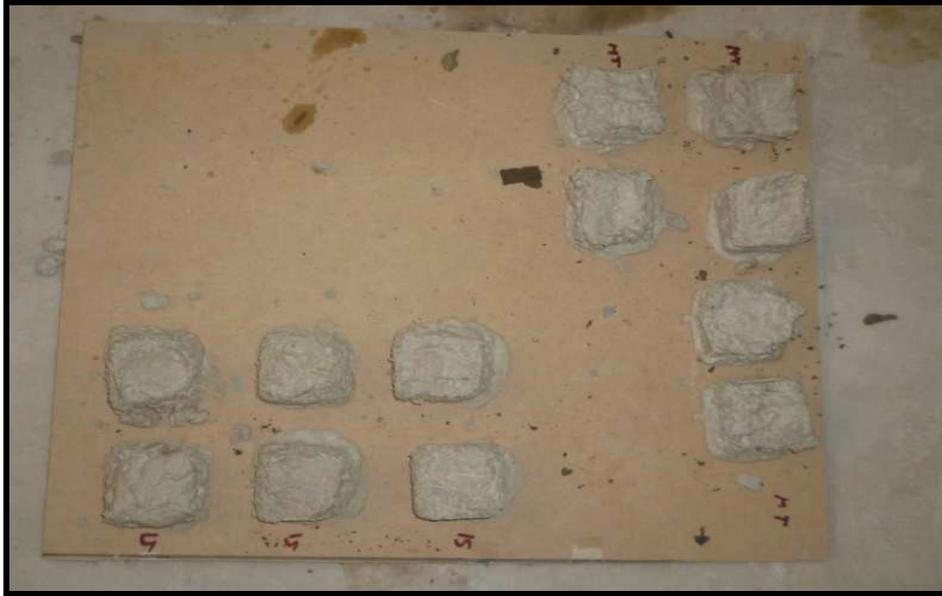
6 moldes de mezcla de mortero tradicional y 6 moldes de mezcla de mortero con adición de 15% de catalizador en sustitución del cemento.
