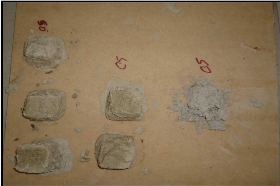
6 moldes de mezcla de mortero con adición de 50% de catalizador en sustitución del cemento.
