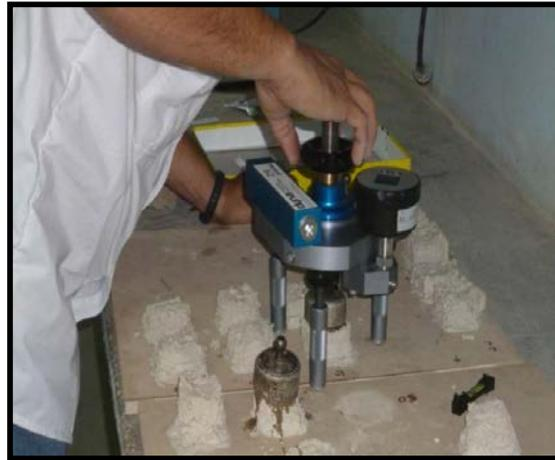
*Equipo para determinación de adherencia DYNA Z16 PROCEQ.*
