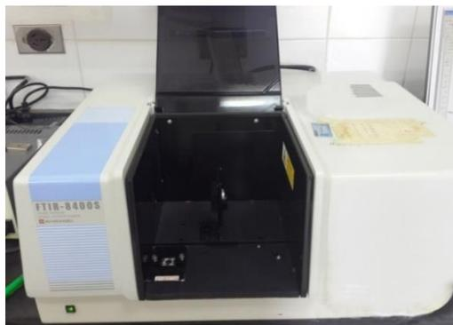
**Figura 3.1** Espectrofotómetro Infrarrojo marca Shimadzu.
