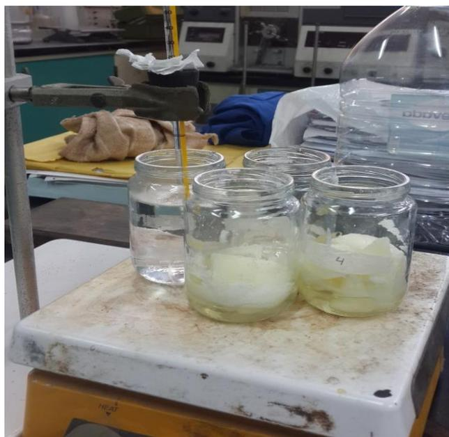
**Figura 3.3** Montaje experimental para la preparación de las dispersiones.
