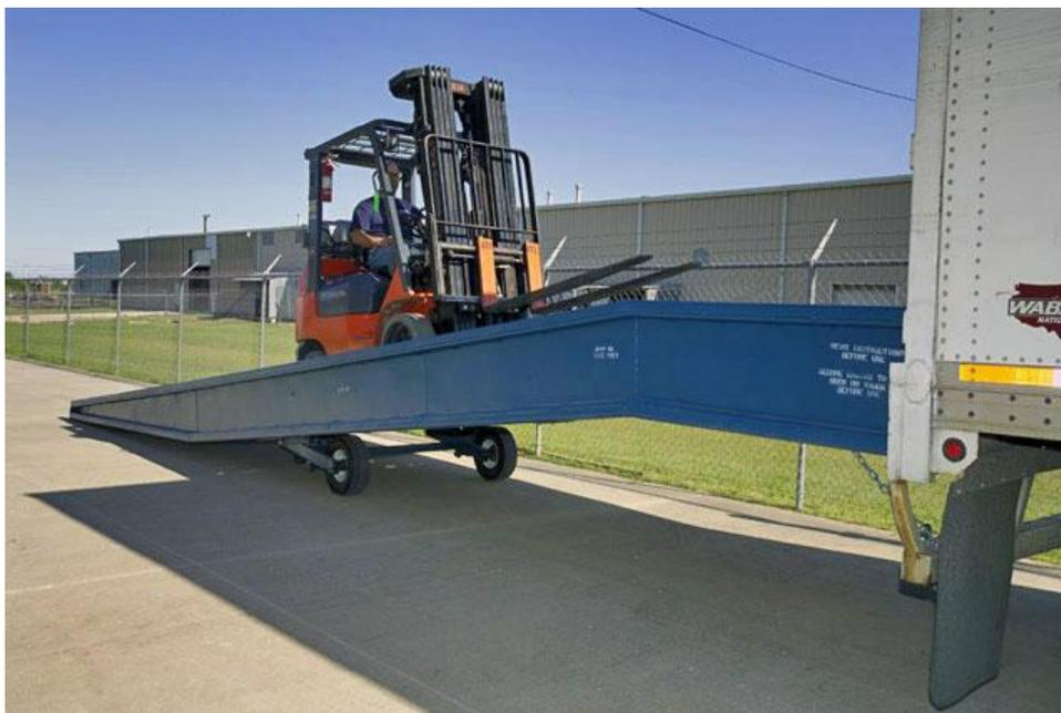
**Figura N°42. Modelo de rampa móvil de carga.** Fuente: (Discount Ramps )
