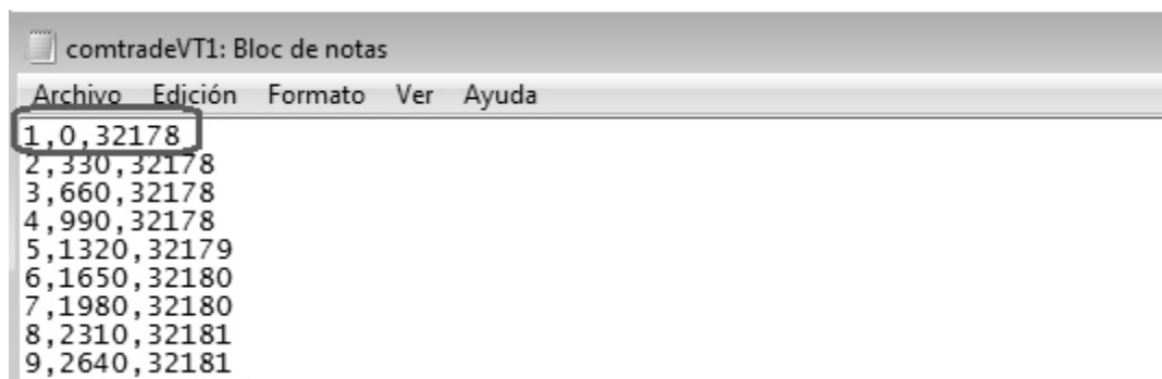
Figura. 4.42. Archivo .DAT de la señal VT1, The Output Processor
