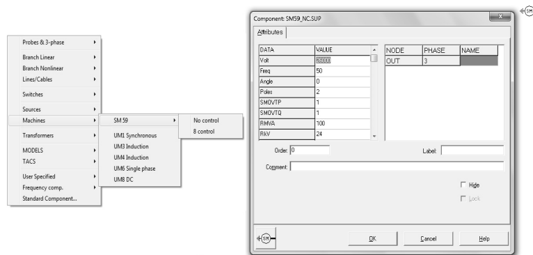
Figura. 2.7. Dirección, ícono y ventana de configuración del SM59 sin control, ATPDraw
