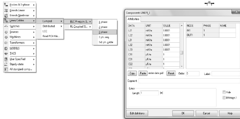
Figura. 2.4. Modelo RLC pi equivalente, ATPDraw
