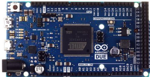
Figura 2.3: Arduino Due
