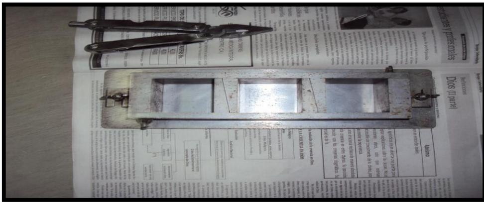
**Fig. 2** Moldes cúbicos de 50.8mm de lado
