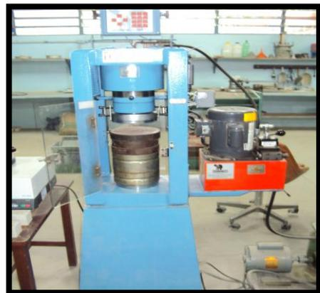
**Fig. 4** Máquina para el ensayo de Resistencia a la Compresión
