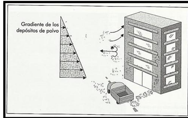
Figura 8. Formación de depósitos de polvo sobre una fachada de concreto. Nota: Tomado de Sánchez de Guzmán Diego. (2003).
