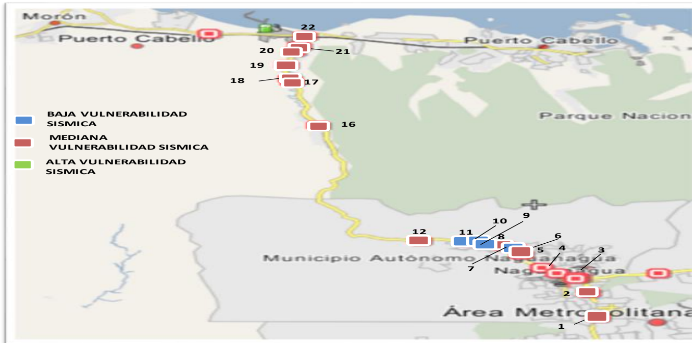
Figura44: Mapa de ubicación de las estructuras de paso de acuerdo a su rango de vulnerabilidad sísmica de la Autopista Valencia-Puerto Cabello
