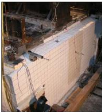
Figura 2.17 Daño Progresivo del Pedestal de Concreto.
