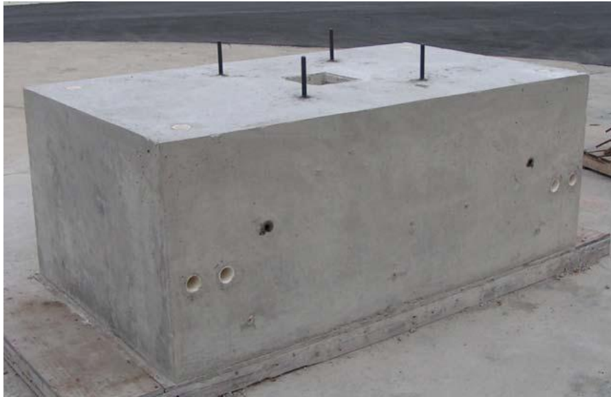
Figura 2.6 Fotografía del pedestal típico ensayado con sus barras de anclaje.
