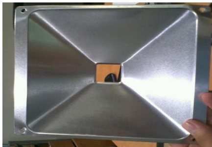
Figura 4.8 – Lámina reflectora de aluminio. Fuente: Propia.
