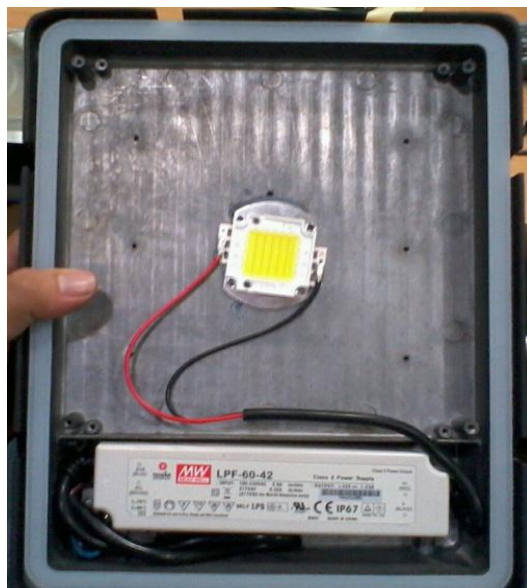
Figura 4.6– Ubicación del chip semiconductor y el driver utilizado para alimentarlo. Fuente: Propia.
