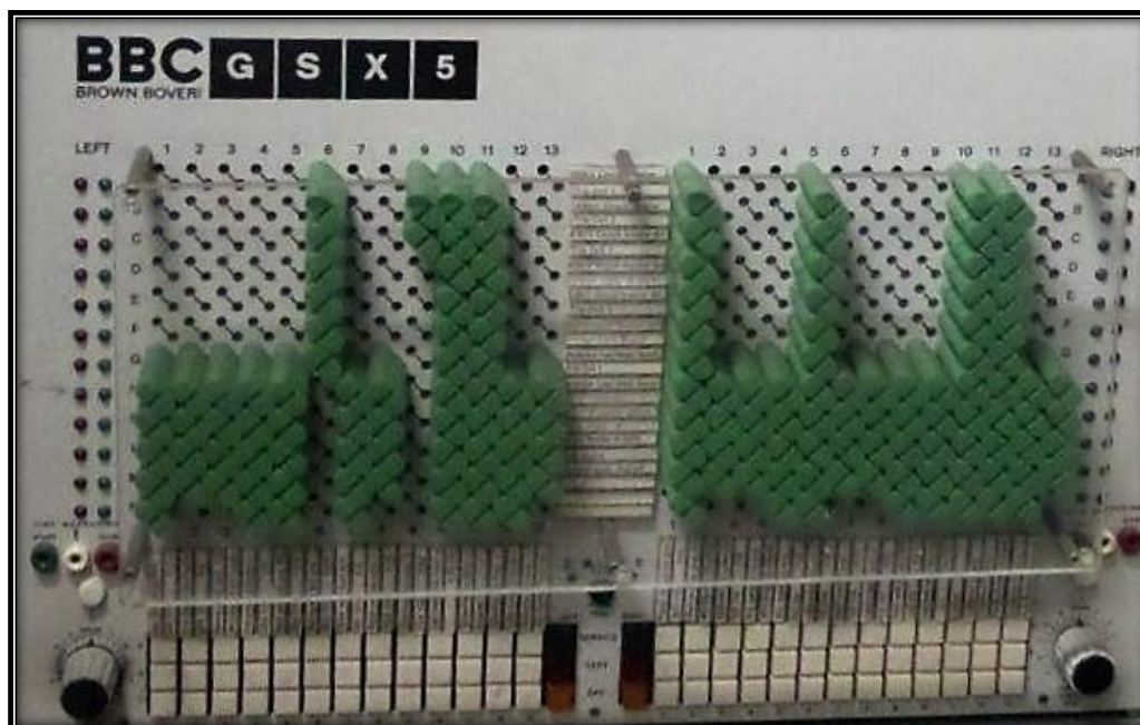
Figura 3.5 Sistema de Protección Electronico GSX5 BBC. Fuente: Elaboración Propia
