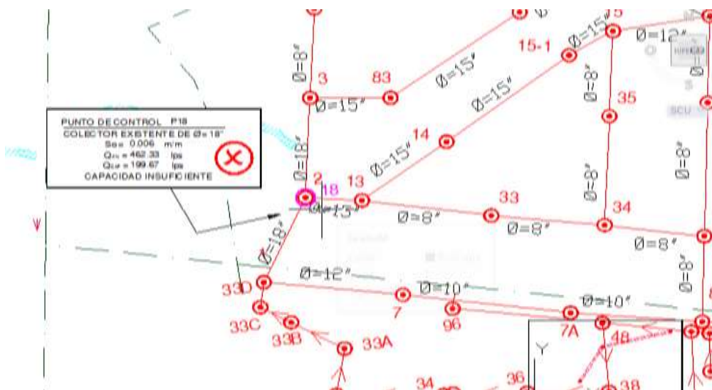
Diagnostico de Puntos de control P18 Urbanización La Trigaleña.
