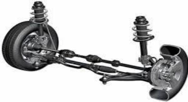
**Figura 2** *Suspensión Independiente Mc Pherson. (Fuente [aficionadosalamecanica.net/suspension](http://aficionadosalamecanica.net/suspension). 2014)*
