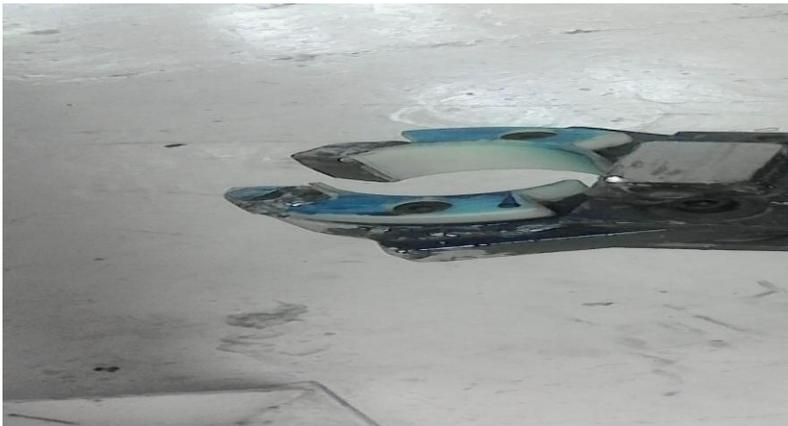
**Figura 85. Sistema de sujeción pinza cerrada.**
