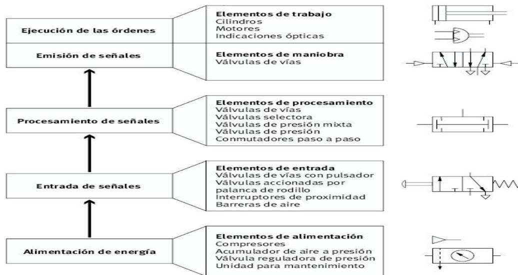
**Figura 18. Esquema Neumático. Fuente [barreda-soto.blogspot.com/neumática](http://barreda-soto.blogspot.com/neumática). 2012**
