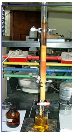
**Figura 3.16. Fracciones de una columna cromatografica**
