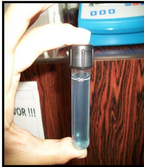
Cubeta contenida de agua residual, Phosporous Reagent A y Phosporous Reagent B
