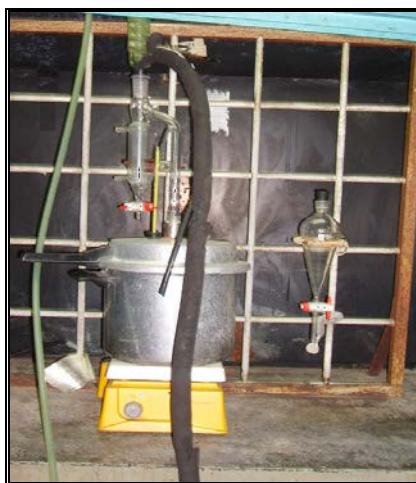
Figura 3.1. Equipo de extracción de aceites esenciales a escala de laboratorio (CIQ). Ilustración original
