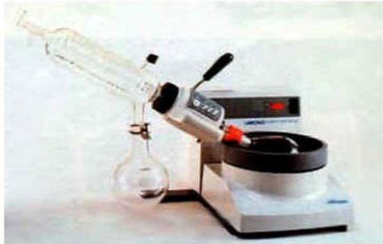
**Figura. 3.4. Equipo rotovaporador.**
