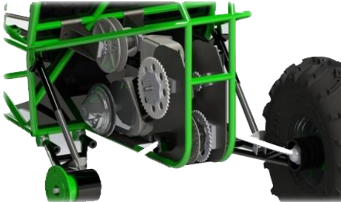
Figura Nº 9 Esquema de montaje del sistema de transmisión del prototipo Baja SAE UC 2014
