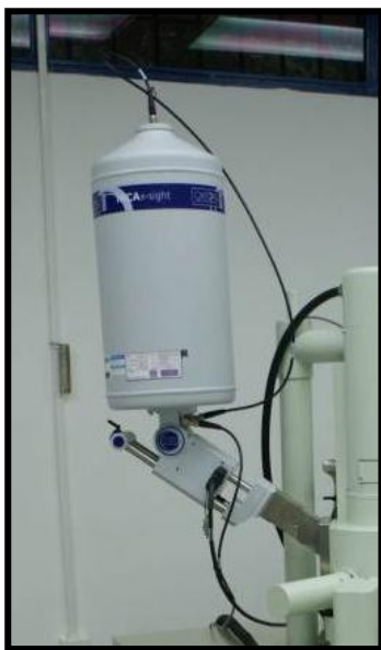
Figura 3.8 Dispositivo EDX acoplado al MEB.
