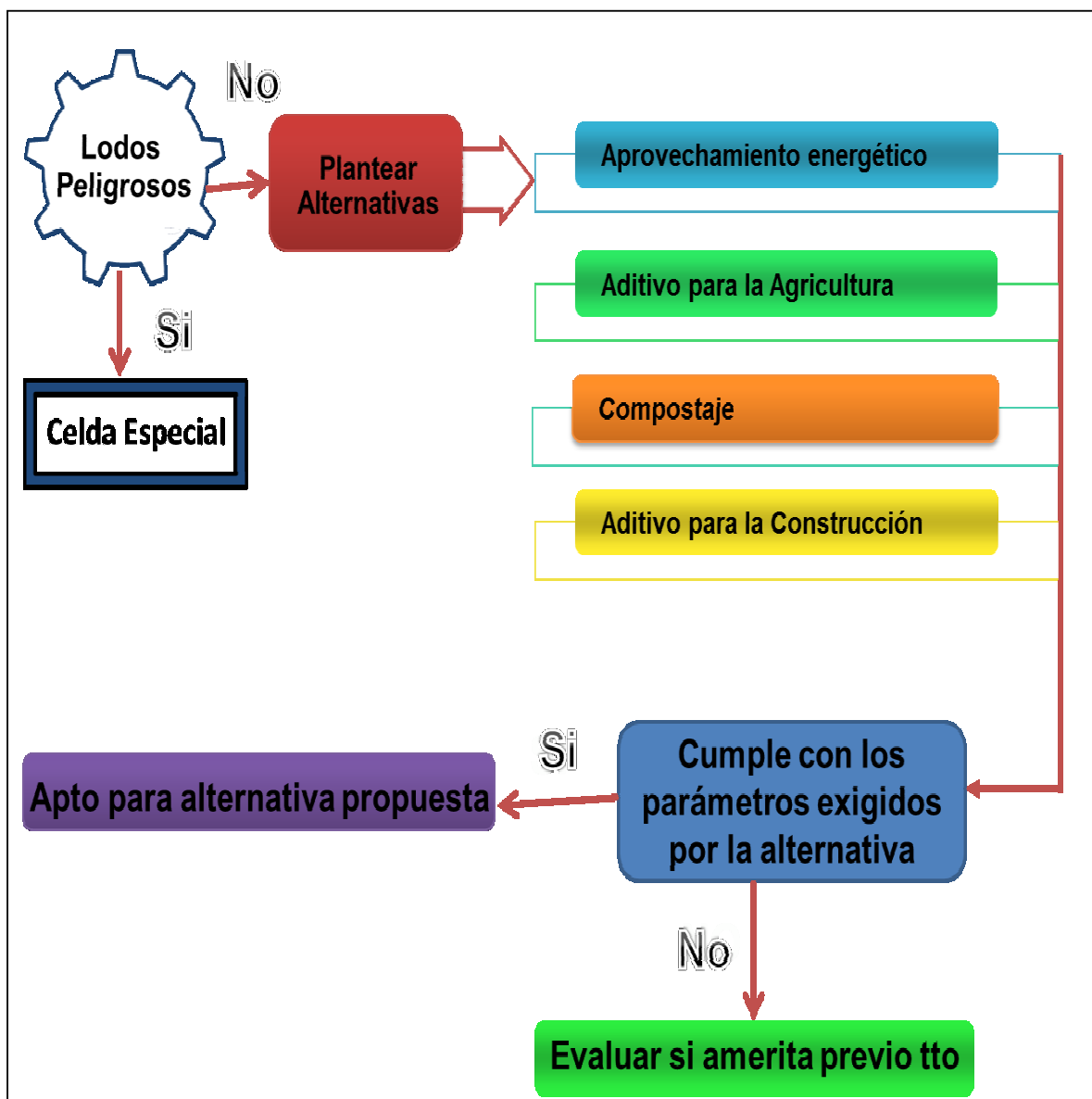
Figura 4.4 Diagrama de flujo para la determinación de posibles alternativas de aprovechamiento de los lodos generados en la planta Dr. Alejo Zuloaga
