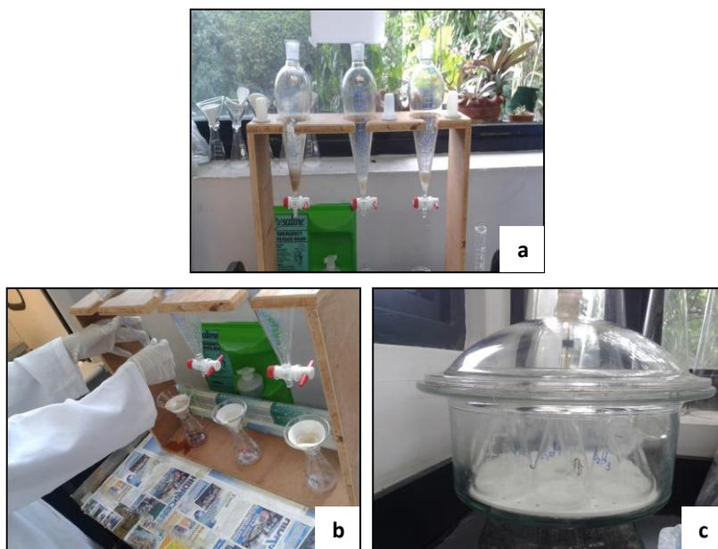
Figura 3.1 Determinación de la concentración de aceites y grasas. a) Reposo de la mezcla, b) Separación de capas y c) Enfriamiento de los matraces.
