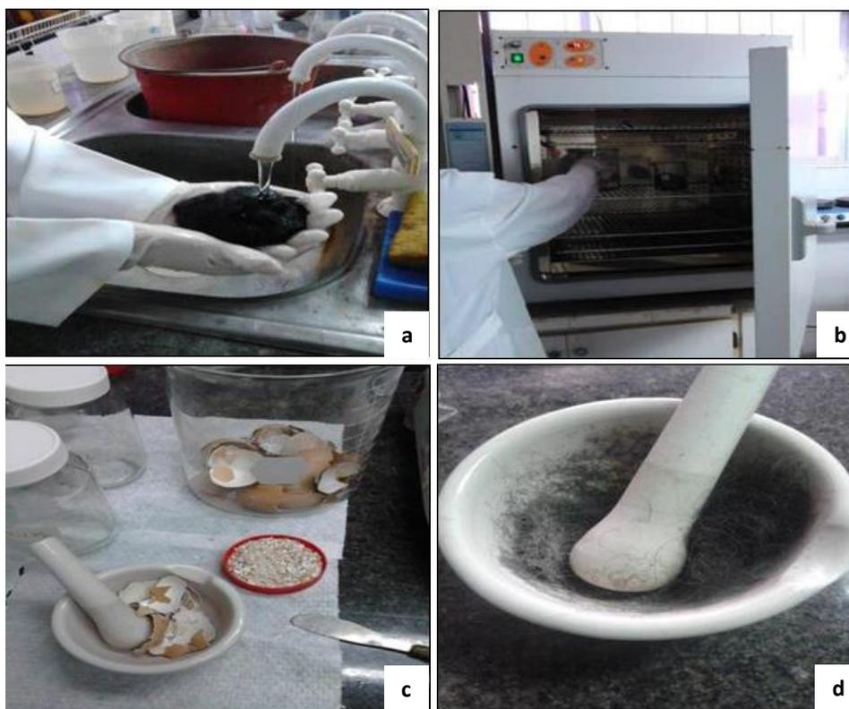
Figura 3.2 Pretratamiento de los bioadsorbentes. a) Lavado de las muestras, b) Secado de las muestras, c) Trituración de las cáscaras de huevo y d) Trituración del cabello humano.
