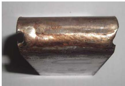
**Fig. 4.22. Probeta expuesta a corrosión durante 168 horas, doblada en U.**
