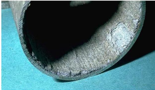
**Fig. 2.12. Corrosión Intergranular. (Perry, 1998)**
