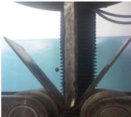
**Figura 3.10. Ensayo de doblado al aire. Fuente: propia.**
