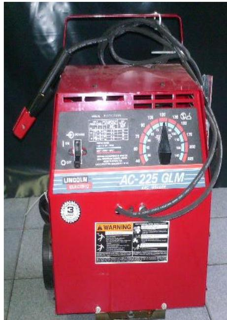
Figura 3.3. Máquina para soldadura utilizada. Fuente: Lincoln, 2008.
