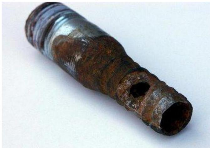
**Fig. 2.13. Corrosión por erosión. (Perry, 1998)**
