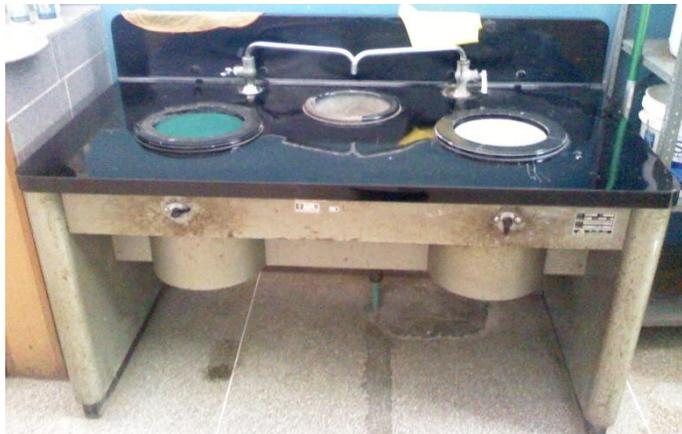
**Figura 3.11. Máquina de desbaste y pulido disponible en el Laboratorio de Materiales de la Facultad de Ingeniería de la Universidad de Carabobo.**
