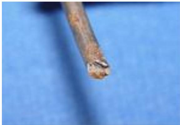
**Fig. 2.14. Corrosión por tensión. (Perry, 1998)**
