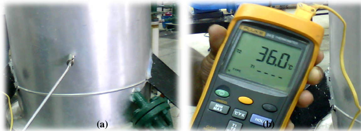
Figura 50. (a) y (b). Ubicación de la termocupla tipo k en el primer punto más bajo del evaporador y el valor de temperatura en ese punto.
