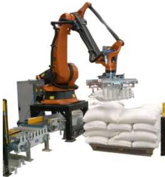
Figura 2.58 Robot paletizador.
