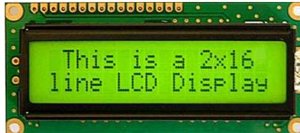
Figura 2.16 Pantalla *LCD* 2x16
