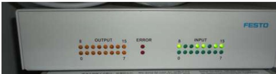
Figura 4.88: Módulo de entradas y salidas
