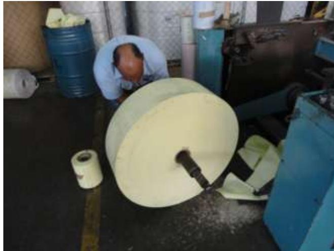
Figura 4.5: Instalación de bobina de papel en cuerpo de alimentación
