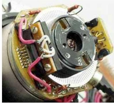
Figura 2.37 Motor de CC con *encoder* en ranuras
