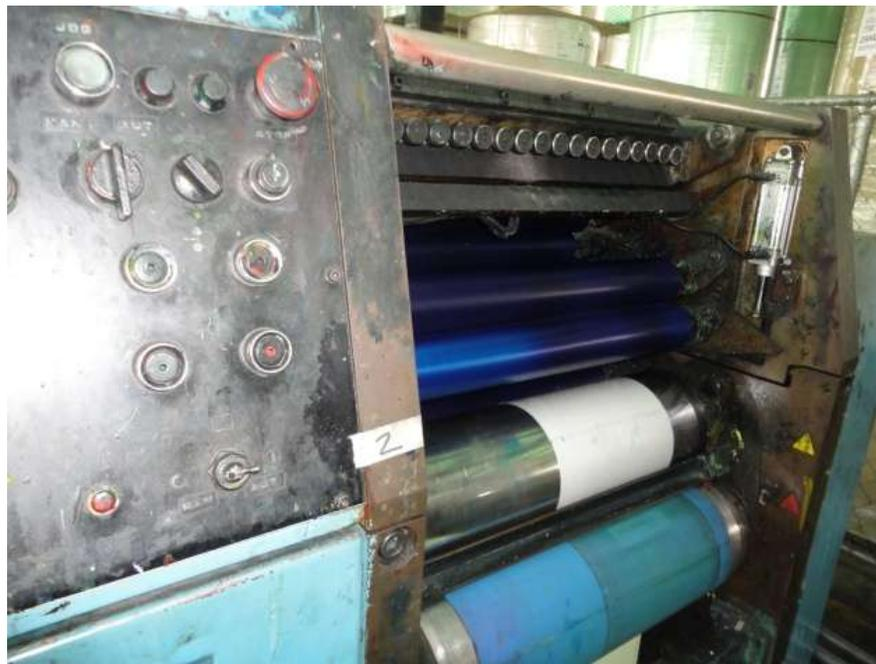
Figura 4.3: Módulo de Impresión offset
