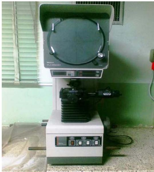
**Fig. 3.2** Perfilómetro .PJ 2500 Mitutoyo. (Fuente propia, 2009).
