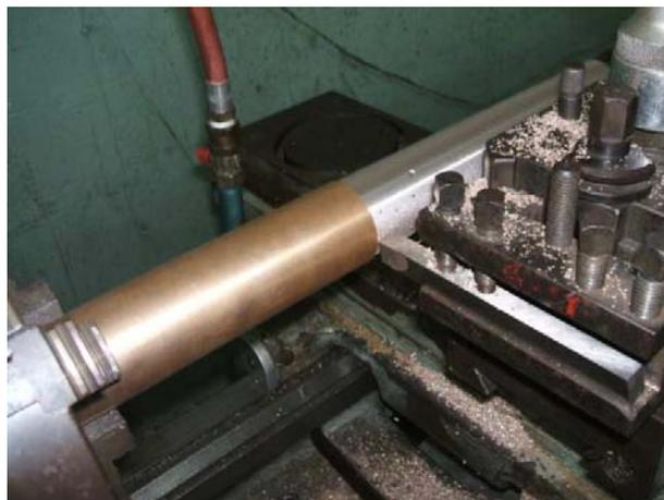
**Fig. 4.1** Operación de cilindrado. (Fuente propia,2009).
