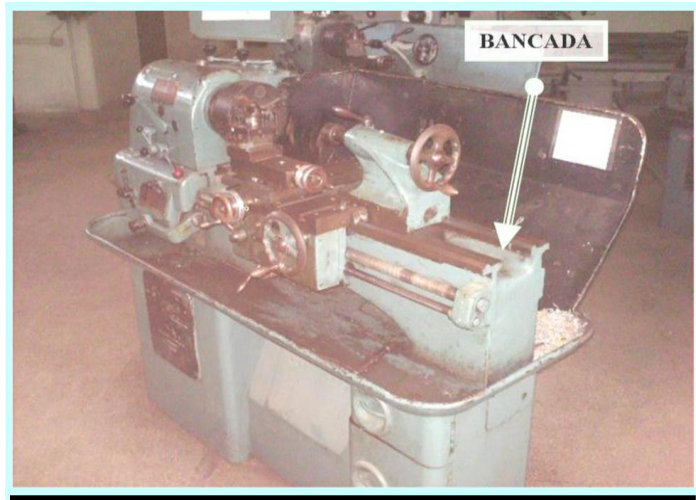
Figura 2.5 Vista de torno paralelo. (Fuente: Sidorovas, 2008)
