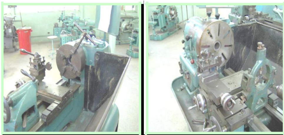
Figura 3.10 Sistema mandril de cuatro muelas y plato de arrastre del torno (Fuente: Sidorovas, 2008)
