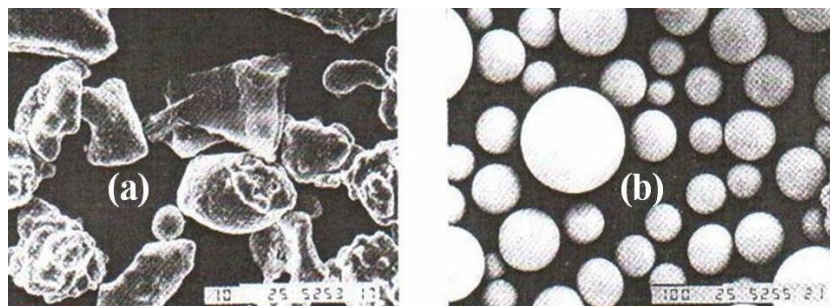
Figura 3.2 (a) Imagen de Microscopio Electrónico de Barrido de las partículas de polvo de hierro fabricadas mediante Atomización. (b) Partículas de polvo de Súper Aleación de Níquel (Udimet 700) fabricadas mediante el proceso de Electrodo Giratorio. (Kalpakjian, 2008)
