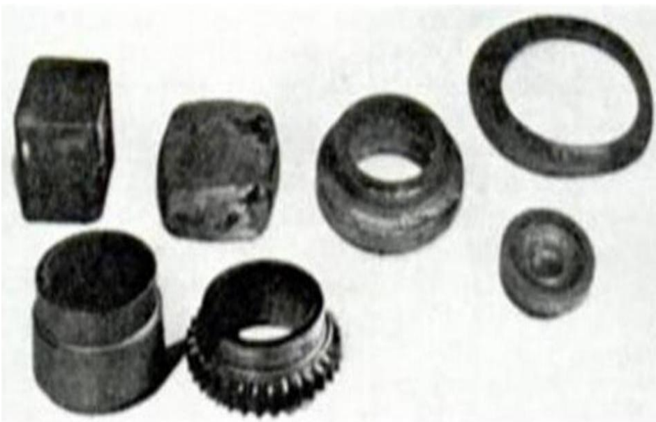
Figura 10.1 Comparación entre la obtención de un primordio de engranaje y el engranaje por forja y por MP. Arriba se ven el material en bruto cortado, la pieza tras la primera forja, el primordio
