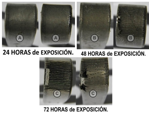
Figura 15: Probetas de doblado del acero inoxidable AISI 201 expuestas a 24, 48 y 72 Horas.
