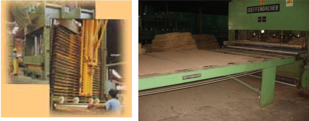
**Figura 2.12** Proceso de prensado en paquete de la lámina de contrachapado.(IMAYA, 2008)
