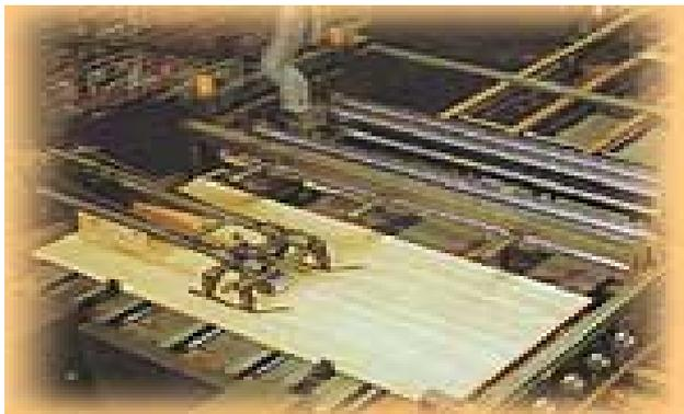
**Figura 2.13** Proceso de encuadramiento de la lámina de contrachapado.(Edimca, 2006)
