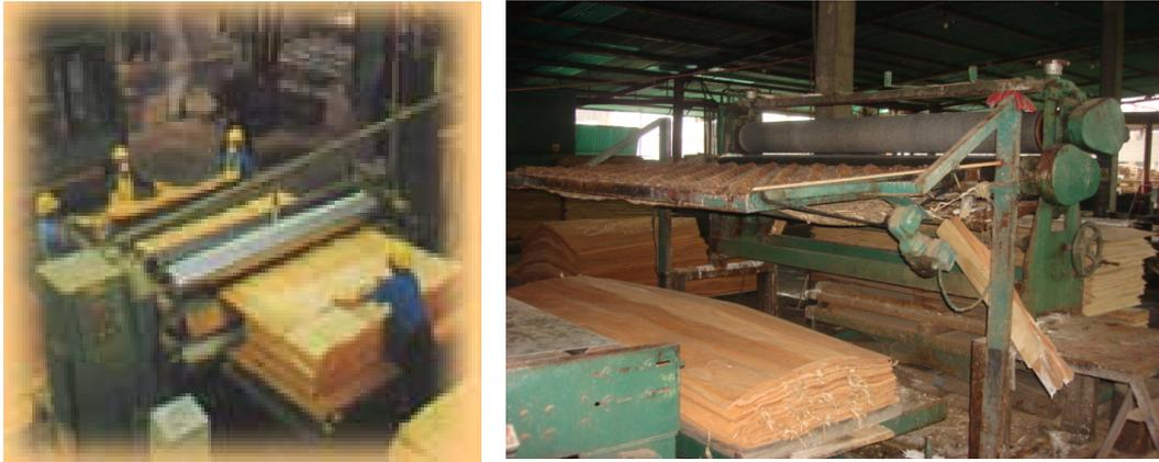
Figura 2.10 Proceso de Encolado de las láminas de contrachapado. .(IMAYA, 2008)
