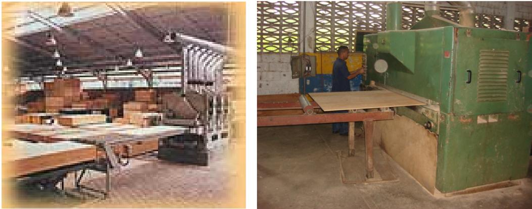
**Figura 2.14** Proceso de lijado y calibración de la zona superficial de la lámina. .(IMAYA, 2008)
