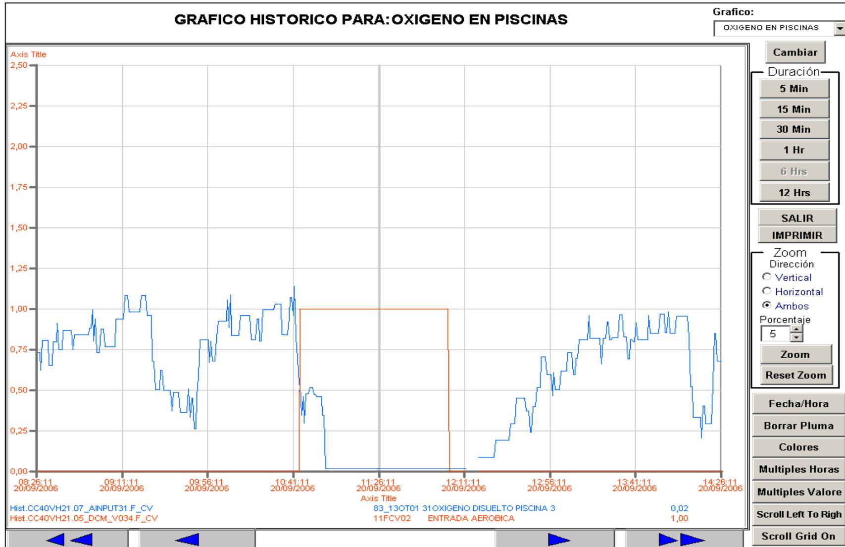
Figura 4.35: Gráfico histórico que muestra el comportamiento del oxígeno disuelto en las piscinas al realizar un desvío intencional al tratamiento aeróbico
