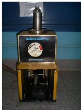
**Figura 3.3. Embutidora Buehler.**
