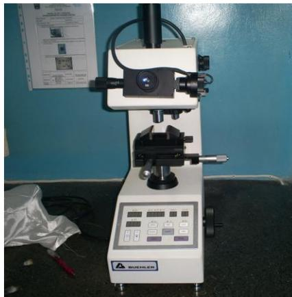
**Figura 3.7. Microdurometro Buehler.**
