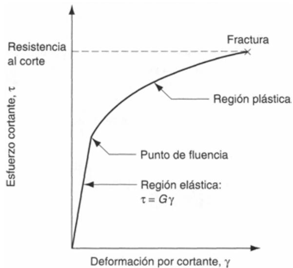
Figura 2.7 Curva esfuerzo-deformación en corte por torsión
