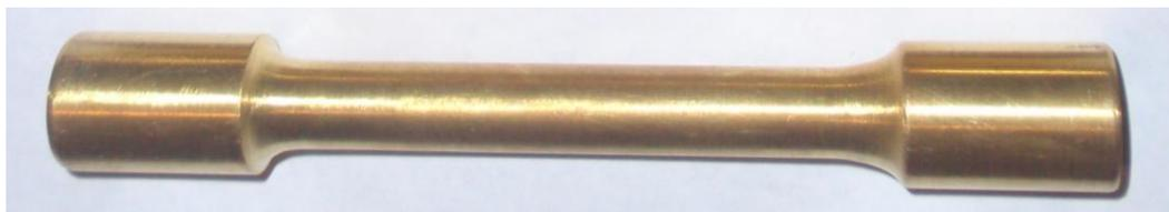
Figura 4.8 Probeta antes de ser utilizada en los ensayos de tracción
