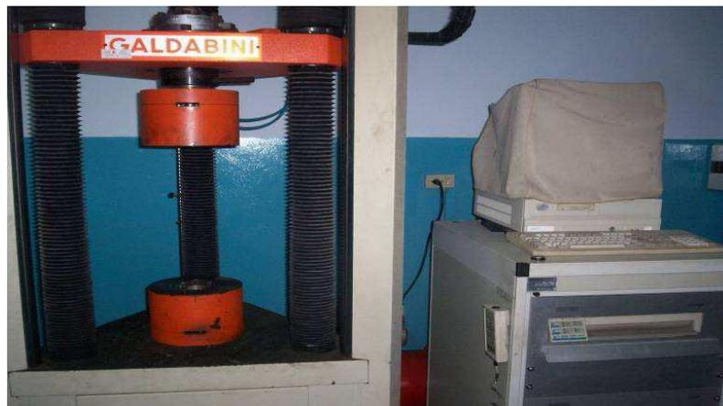
Figura 3.12 Máquina universal de ensayo de materiales. Marca: Galdabini
