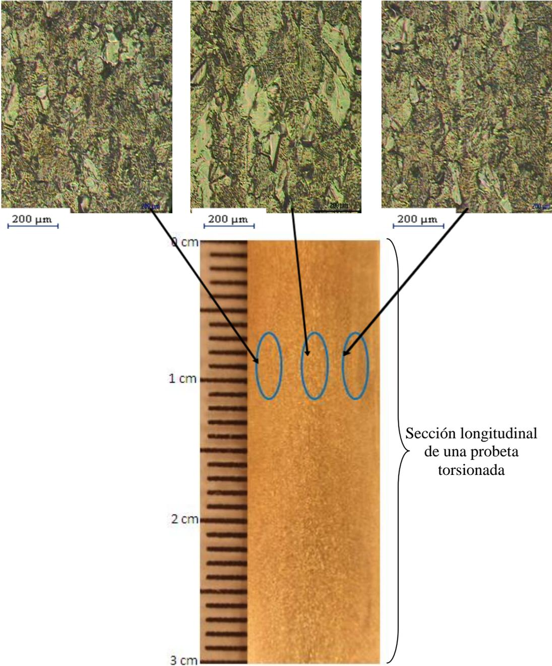
Figura 4.24 Imágenes macroscópicas y microscópicas de una probeta de la aleación UNS C36000 en condición de recocido luego de la torsión
