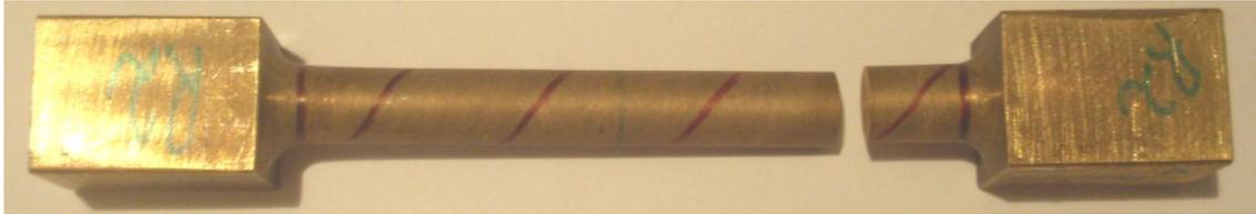
Figura 4.3 Condición de la probeta T2-R360 una vez finalizado el ensayo de torsión
