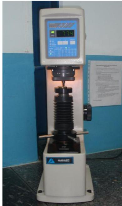
Figura 3.13 Durómetro digital BUEHLER
