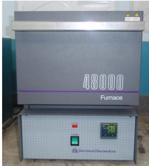
Figura 3.4 Horno Thermolyne, utilizado en los tratamientos térmicos
