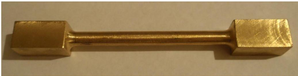
Figura 4.1 Probeta antes de ser utilizada en los ensayos de torsión
