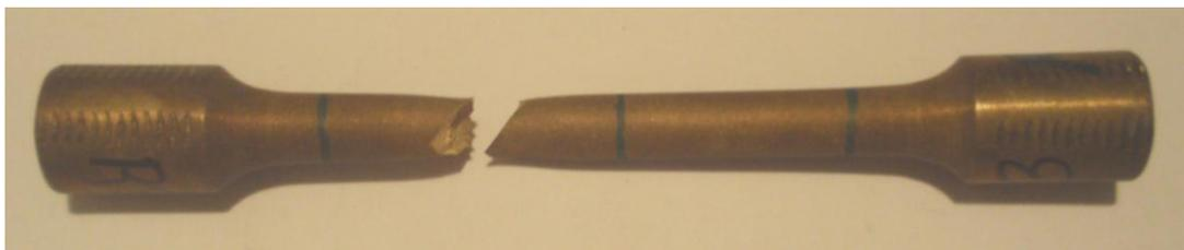
Figura 4.12 Condición de la probeta t3-R360 una vez finalizado el ensayo de tracción
