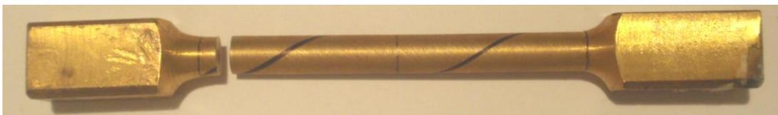
Figura 4.7 Condición de la probeta T6-N377 una vez finalizado el ensayo de torsión
