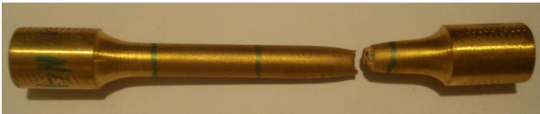
Figura 4.10 Condición de la probeta t4-N360 una vez finalizado el ensayo de tracción
