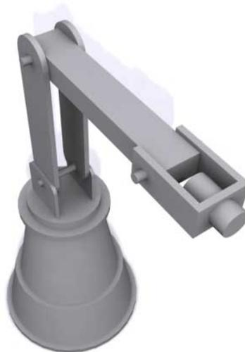
Figura P07-A: Prototipo de brazo mecánico: Brazo industrial de 4 ejes (RI4e).
