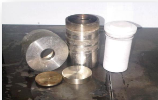
Figura 3.5 Reactor hidrotérmico construido de acero inoxidable y teflón.
