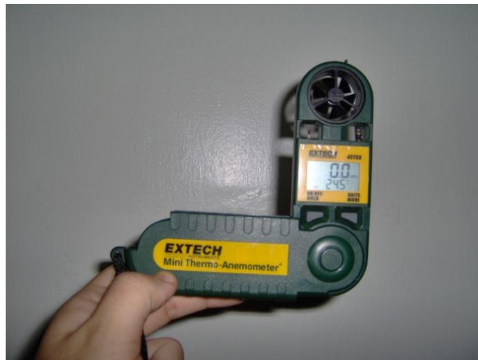
Figura 3.4 Anemómetro digital Extech
