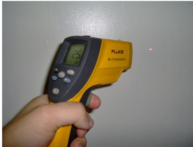
Figura 3.3 Medidor de temperatura FLUKE 66
