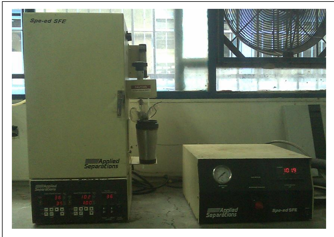
Figura a. Equipo de extracción supercrítica del Centro de Investigaciones Químicas.
