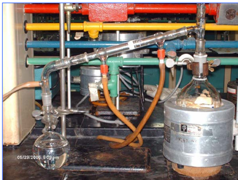
Equipo de destilación al vacío
