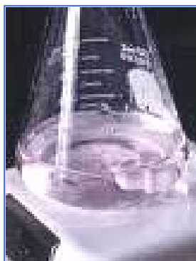
Ensayo por titulación empleando como indicador fenolftaleína
