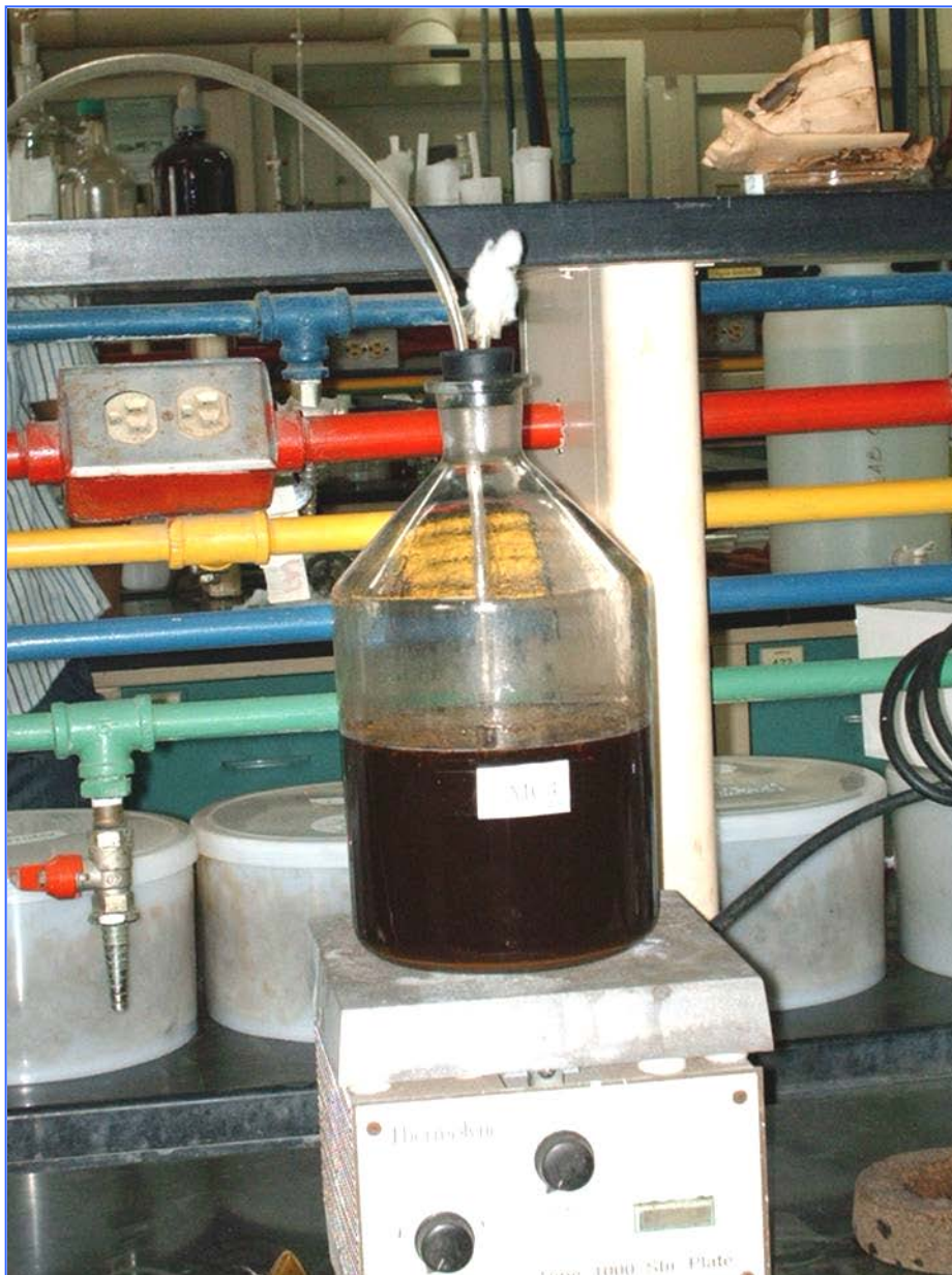
Proceso de fermentación sumergida utilizando melaza de caña como fuente de carbohidratos
