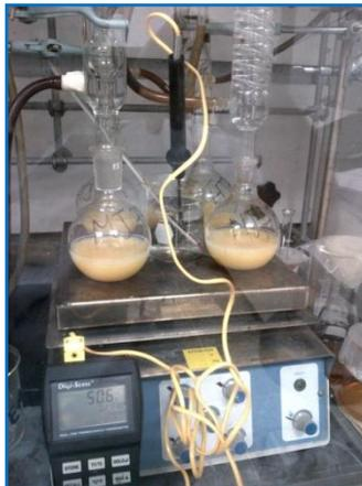
**Figura 3.2** Montaje de la reacción de transesterificación
