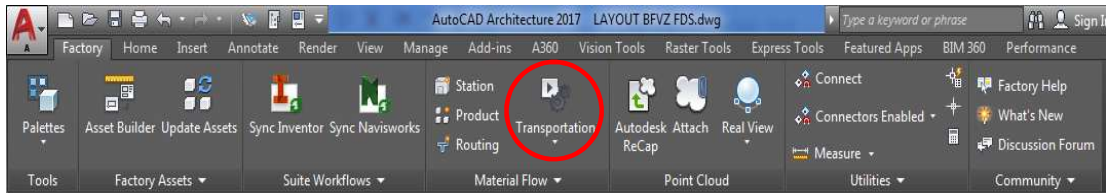
Figura 15. Comando Transportation para análisis de distribuciones en planta.
