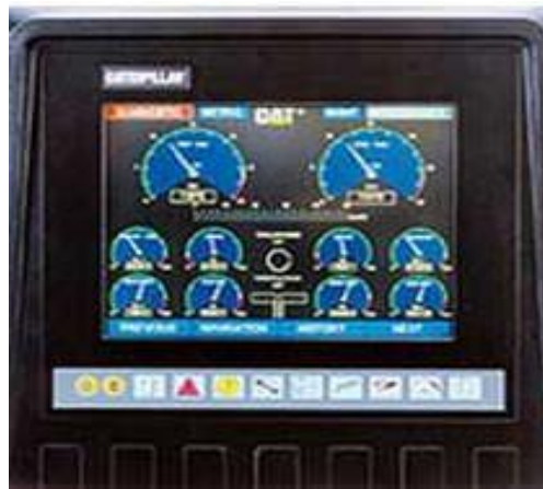
Figura 30 Sistema de control del motor (Caterpillar 2012)
