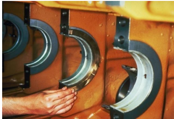
Figura 26: Cojinetes y concha de bancada (Caterpillar 2012)
