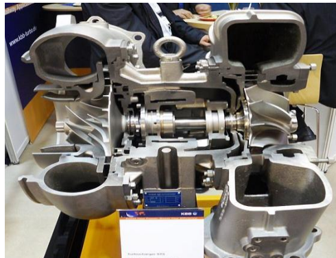
Figura 8 Turbina seccionada Ing. Enrique Emilio Massi (2011)
