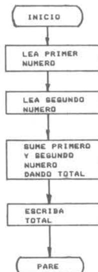
Figura 3-6. Diagrama de flujo de un programa
