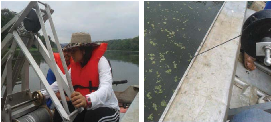
Figura 216: Descenso de la pesa hasta aflojar la guaya.
