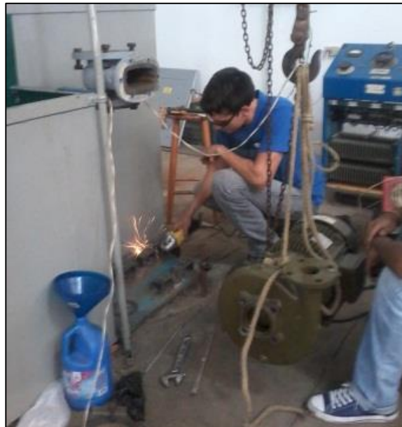
Figura 7. Fabricación de soportes metálicos inferiores de la bomba centrífuga del sistema de turbina Francis y turbina Pelton del Laboratorio de Hidráulica, Universidad de Carabobo.
