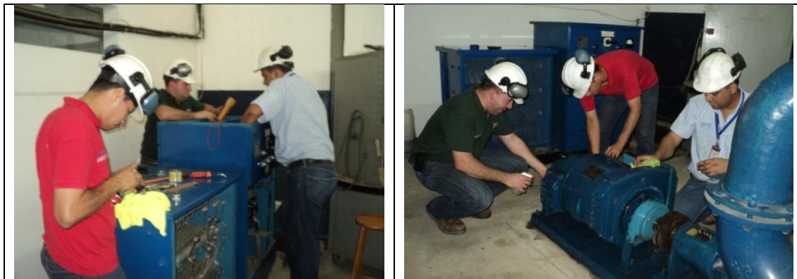
Figura 2. Evaluación del estado de la unidad motora del banco de Turbina Kaplan por personal de CORPOELEC-Planta Centro en el Laboratorio de Hidráulica “Elías Sánchez Díaz” , Universidad de Carabobo.
