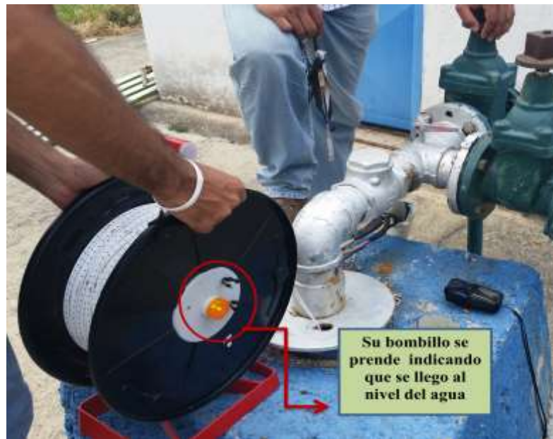
Figura 5: Toma de nivel del agua con la sonda.
